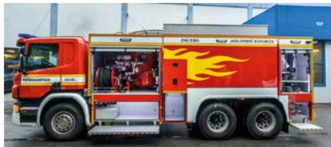
Zudem steht bei allen Löschanlagen die einfache und effektive Handhabung für den Anwender im Vordergrund. Sie erhalten Schlauchhaspeln mit Federrückzug, elektrischem oder pneumatischem Rückzug. Die Auslösung der Ventilsteuerung der Löschanlagen kann sowohl manuell als auch elektrisch oder pneumatisch erfolgen.
